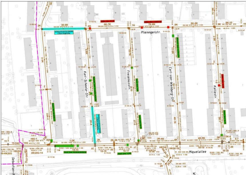
Sanierungsplanauszug Westend Nord Sanierungsbereich „Miquelallee“
